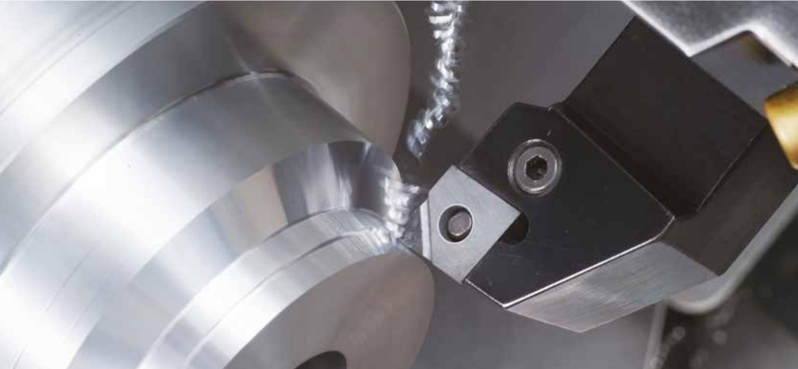
Grado super duro per la lavorazione delle leghe di alluminio
